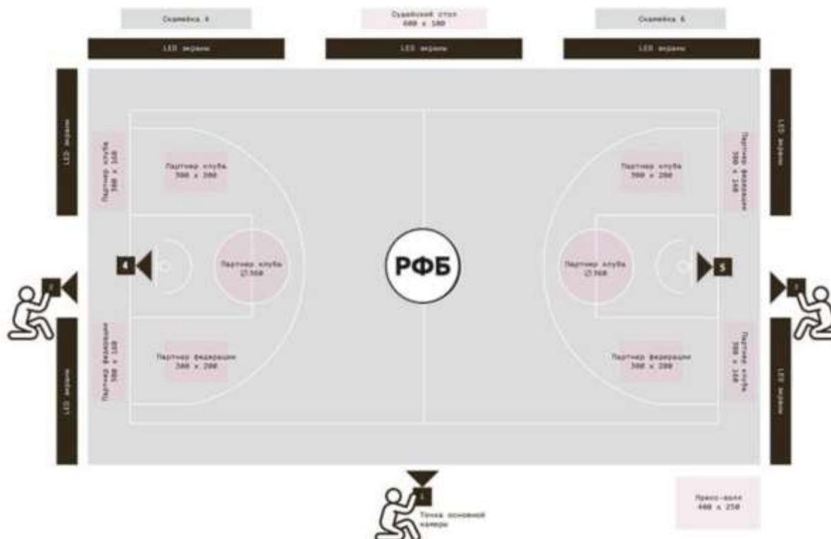
**Камера 1** - Основная камера (общий план). Устанавливается на видеоштативе с противоположной стороны от судейского стола и скамеек игроков, но при условии, что за судейским столом имеются в наличии трибуны для зрителей.
